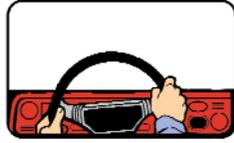
Entonces, empuje hacia arriba con la mano izquierda hasta que esté en la posición de las 11. Repita esta secuencia hasta que haya terminado de dar la vuelta. Invierta el movimiento para enderezar el vehículo.
